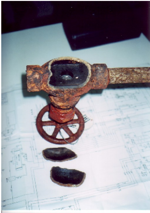
バルブ破損状況
