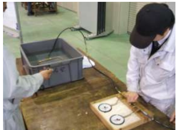
銅管加工と気密試験
