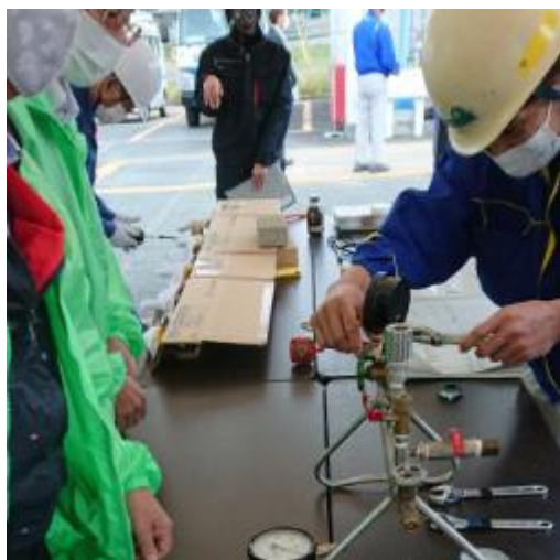
圧力計取替え実習、工具の使用法
